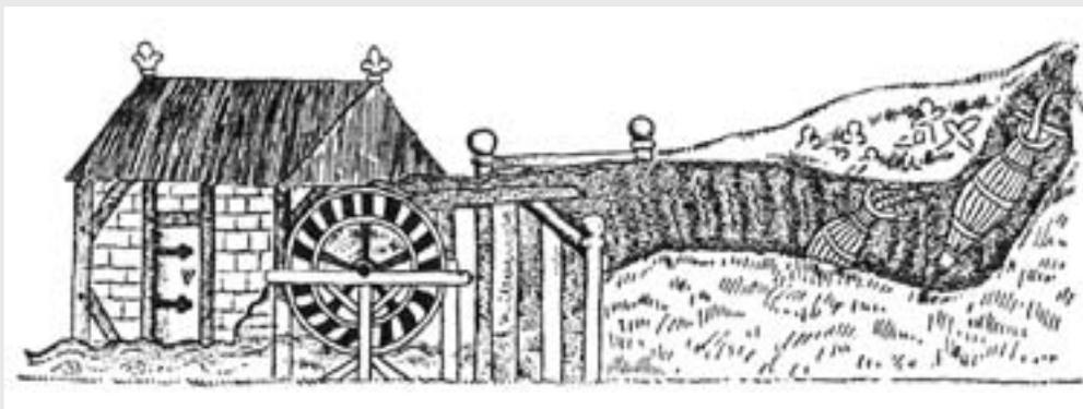
*Disegno di un mulino idraulico con ruota a cassette (secolo XIV)*
